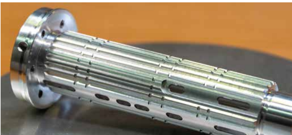
Hnací hřídel, opracováno nástrojem na výrobu ozubení Schwanog
