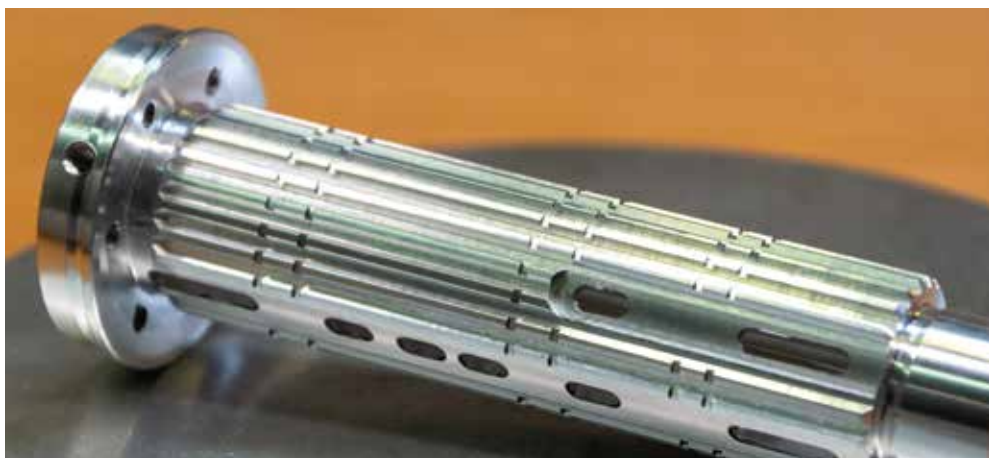
Arbre de transmission usiné avec les outils de brochage d'engrenages Schwanog
