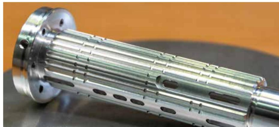
Albero di trasmissione, lavorato con l'utensile di dentatura Schwanog
