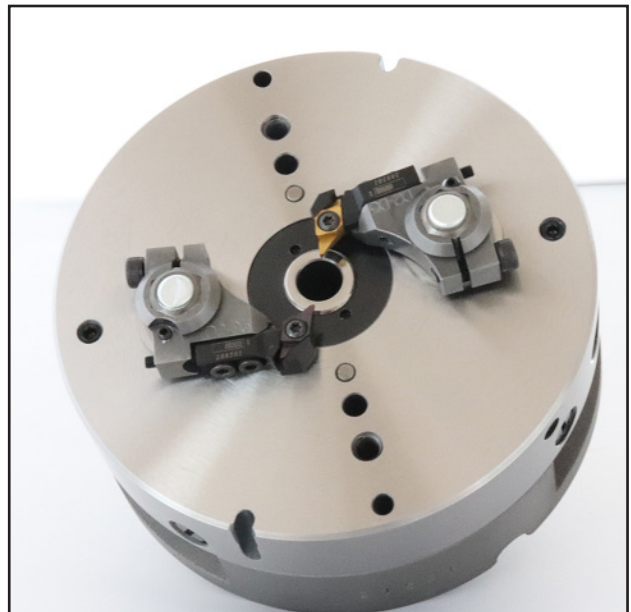
Umgebauter D2 120 Ventura Kopf auf sechskant
