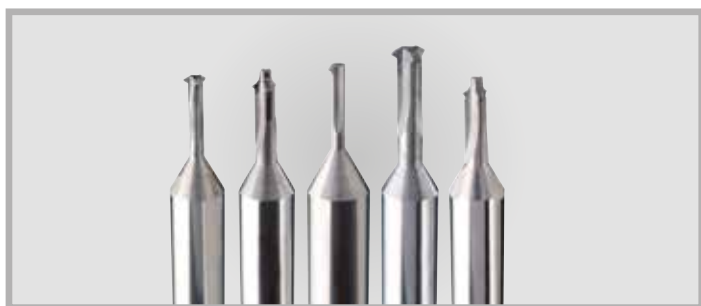
Okružovací frézování vnitřních závitů
