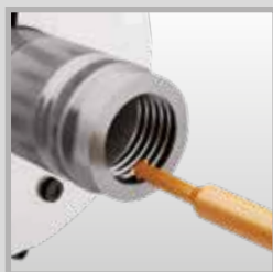
Frézování vnitřních závitů
