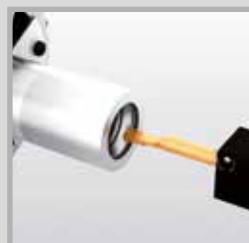
Vnitřní zapichování a soustružení
