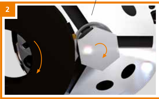
Pozice pro záběr (náběh nástroje) Nástroj začíná se zhotovením vícehranu
