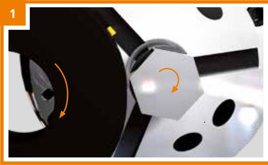
Nástroj i obrobek mají stejný směr otáčení.
