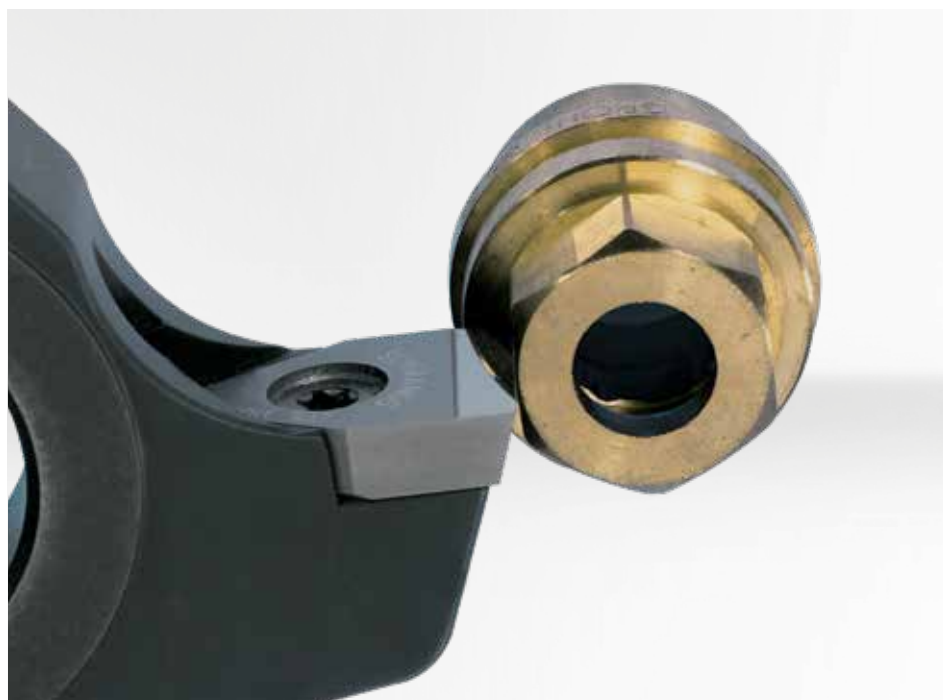
Frézování vícehranů na soustruhu pomocí systému PWP společnosti Schwanog: Pro zapichování.
