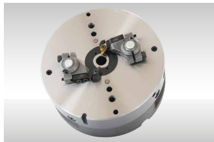
Přestavěná hlava D2 120 na šestihřan
