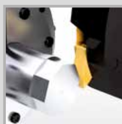
Frézování vícehranů na soustruhu
