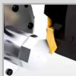
Frézování vícehranů na soustruhu
