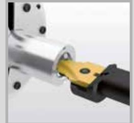
Formbohren mit Wechselplatten
