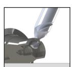
FORMBOHREN QUERBOHRUNG UND FASEN RÜCKSEITE
