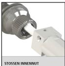
STOSSEN INNENNUT Werkzeug: VHM D8x49 1S Schnittdaten: Zustellung: 0,08 / Hub vf = 10 m/min
