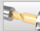
Formbohren mit Vollhartmetallbohrer
