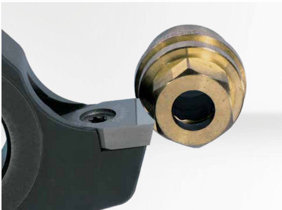
Mehrkantschlagen mit dem Schwanog-PWP-System: Zum Einstechen.
