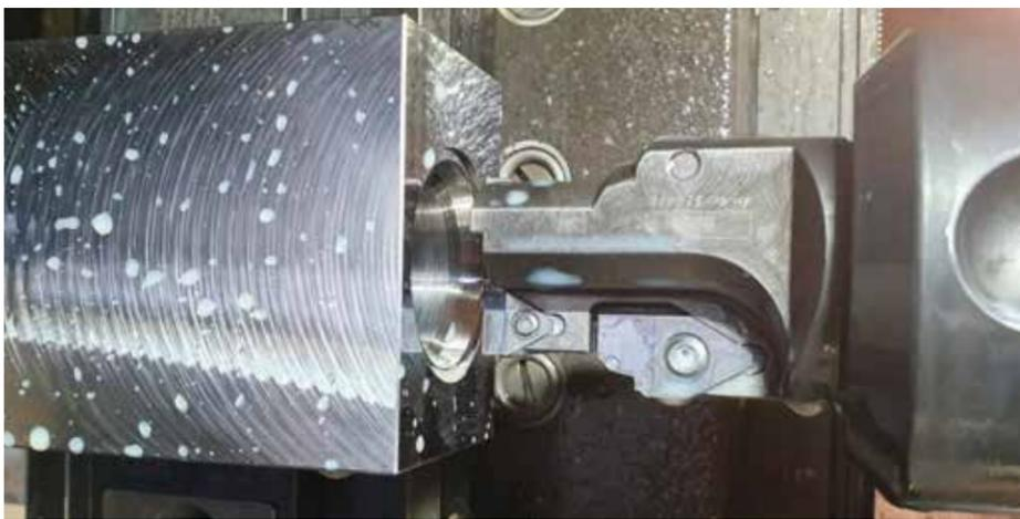
Ventilblock-Bearbeitung mit Schwanog Formbohrer und PWP-Wechselplatten
