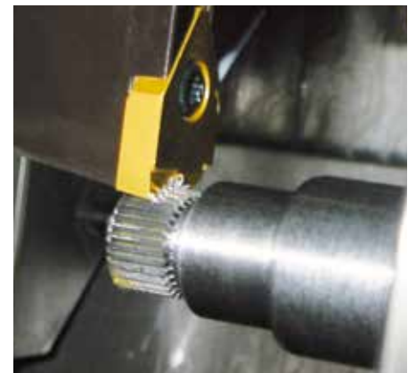
Schwanog Werkzeug und Drehteil mit Kerbverzahnung.
