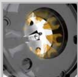
Łuszczenie gwintów zewnętrznych
