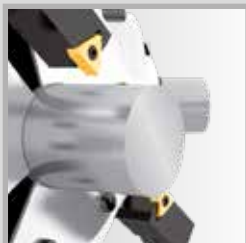
Tronzado exterior sobre máquinas de ciclo circular
