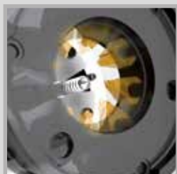
Łuszczenie gwintów zewnętrznych
