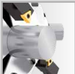
Toczenie kształtów zewnętrznych na maszynach transferowych
