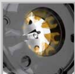
Łuszczenie gwintów zewnętrznych
