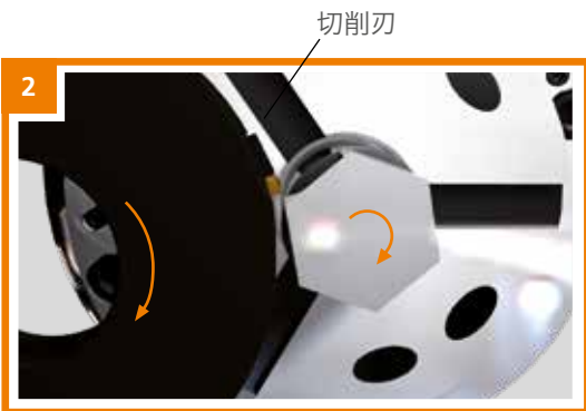
2 接触位置（刀具接触） 刀具与多棱车削同时开始
