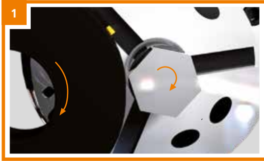
L'utensile e il pezzo presentano la stessa direzione di rotazione.
