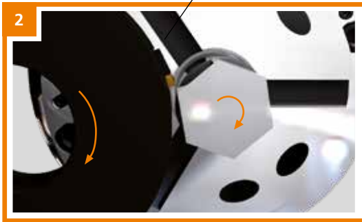
Posizione di intervento (avanzamento dell'utensile). L'utensile inizia con la poligonatura.
