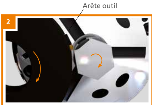
2 Position d'insertion (plongée de l'outil) L'outil démarre le polygonaage.
