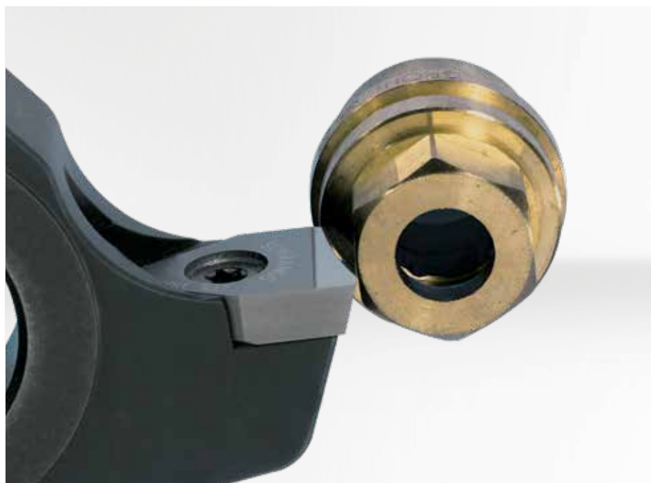
Polygonnage à l'aide du système PWP de Schwanog : En plongée.
