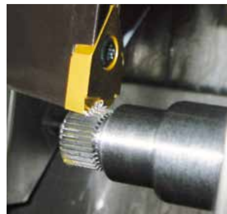
Herramienta y pieza de torno de Schwanog con dentado de entalladura.
