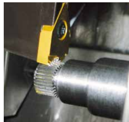
Utensile Schwanog e pezzo tornito con dentatura.
