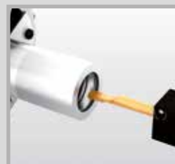
Scanalatura e tornitura interna
