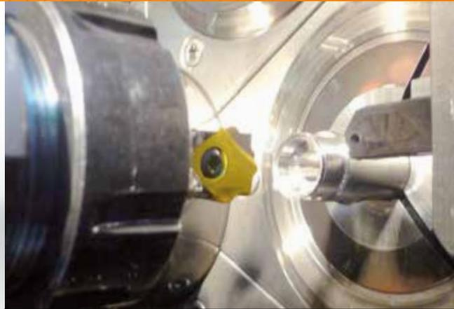
Perforación de forma con plaquitas intercambiables
