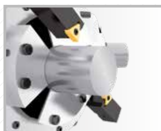
Fonçage extérieur sur machines transfert rotatif
