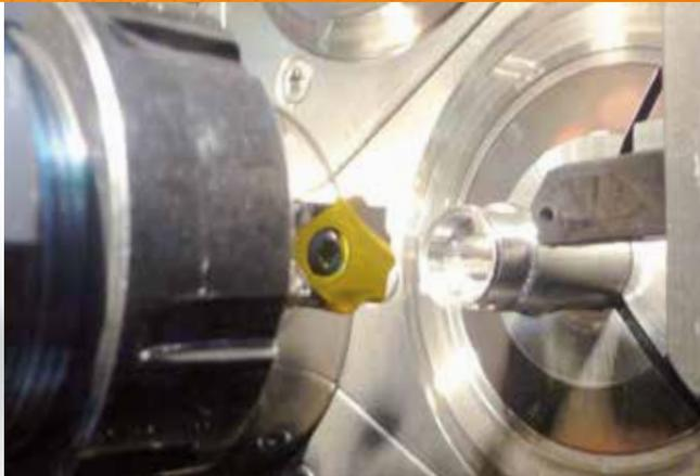
Perçage de forme avec plaquette interchangeable
