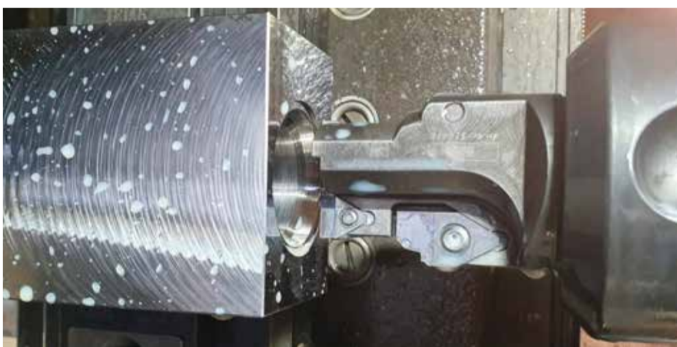
Usinage du bloc de vannes avec mèche de forme Schwanog et plaquettes amovibles PWP
