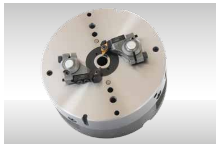
Mandrin de 120 pour D2 reconditionné avec arbres hexagonaux
