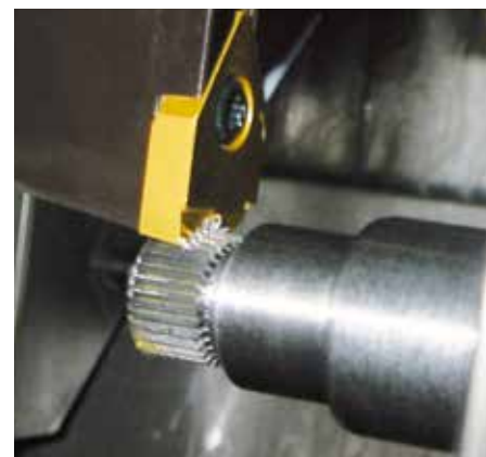
Outils Schwanog de taillage de denture et pièce réalisée.
