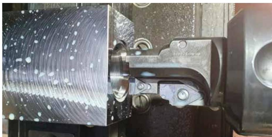
Lavorazione di un blocco valvole con la punta per la foratura di forma Schwanog e inserti intercambiabili PWP
