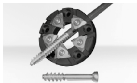
Schwanog system WEP ze śrubą
