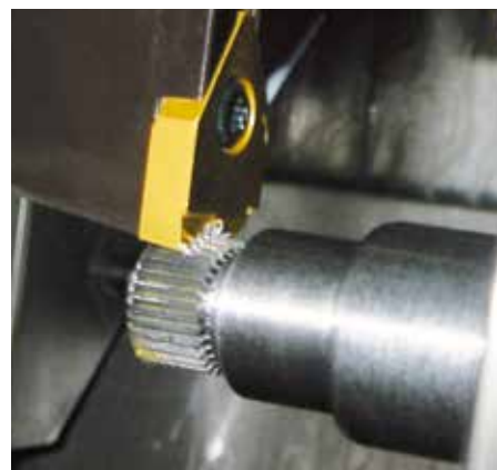
Narzędzie Schwanog i detal z wielowypustem.
