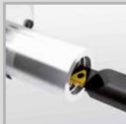
Toczenie kształtów wewnętrznych
