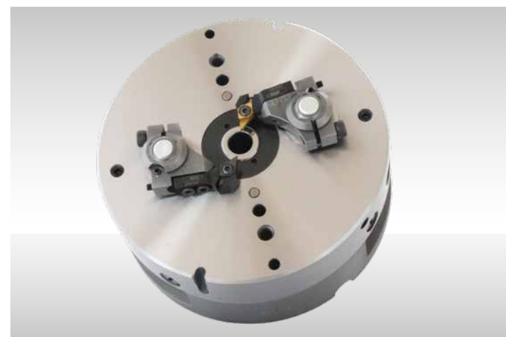
Przebudowana głowica D2 120 na sześciokąt
