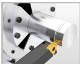
Toczenie kształtów zewnętrznych
