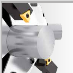
Außenstechen auf Rundtaktmaschinen
