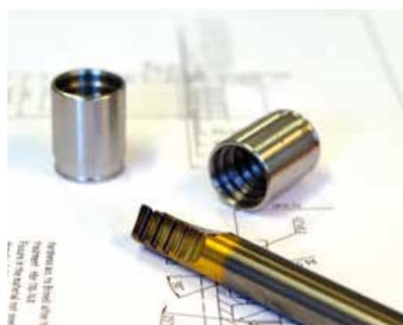
Outils de fonçage en carbure monobloc pour la réalisation de formes intérieures
