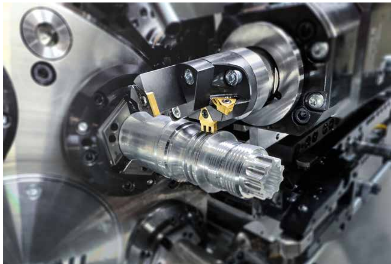
HDT-2.0- Outil combiné, plaquette de tronçonnage de forme en position d'usinage
