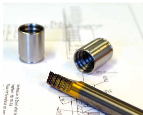
Herramienta VHM de tronzado de Schwanog para el mecanizado interior
