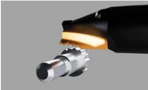
Si el material de la pieza que se va a mecanizar tiene una resistencia a la tracción muy alta, se llega a los límites del mortajado. En estos casos se ha demostrado la idoneidad del fresado con el sistema PWP de Schwanog. Con la placa intercambiable de 2 filos, pueden fresarse formas especiales con una precisión de  $\pm 0,02$  mm. La posibilidad de cambio rápido de las placas y la alta precisión de cambio generalmente permiten seguir trabajando inmediatamente sin necesidad de volver a ajustar.
