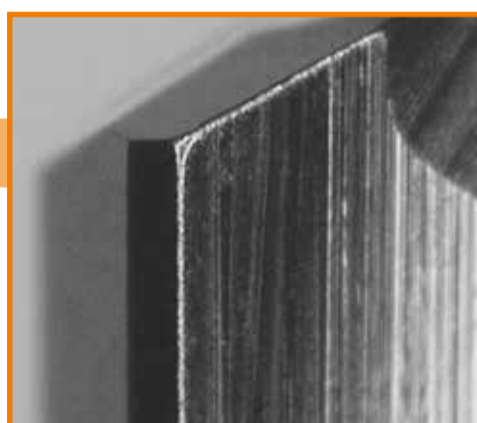
切削刃圆角 R=0.02 mm
