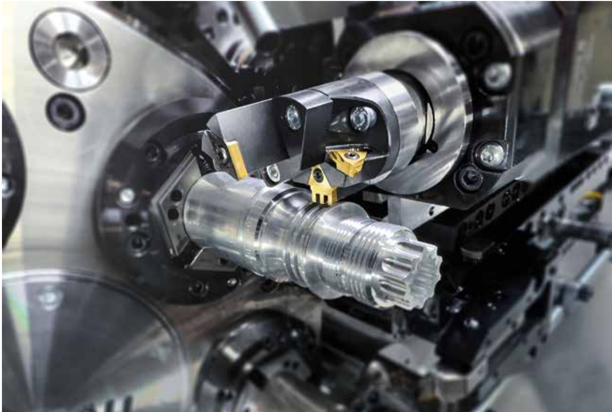
HDT-2.0 复合刀具（切断模式）
