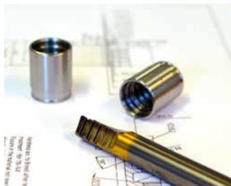
VHM Schwanog Stechwerkzeug für die Bearbeitung von Innenkonturen
