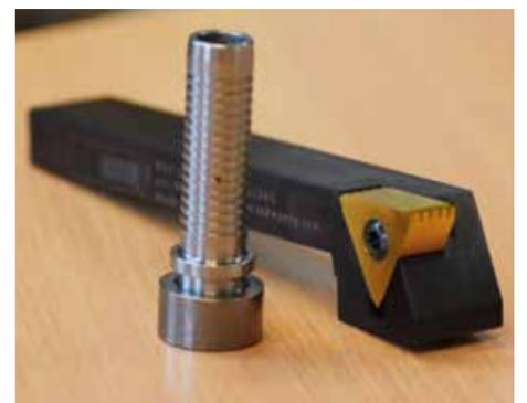
Schwanog WEP-System für das Außenstechen von Nuten
