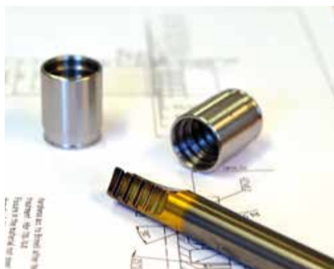
定制的整体硬质合金 VHM内径刀具
