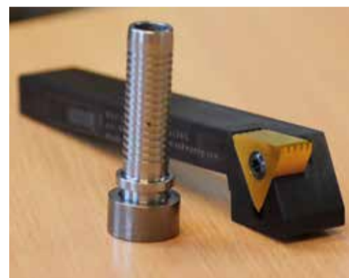
定制的三个刀刃WEP刀片 外切槽刀具
