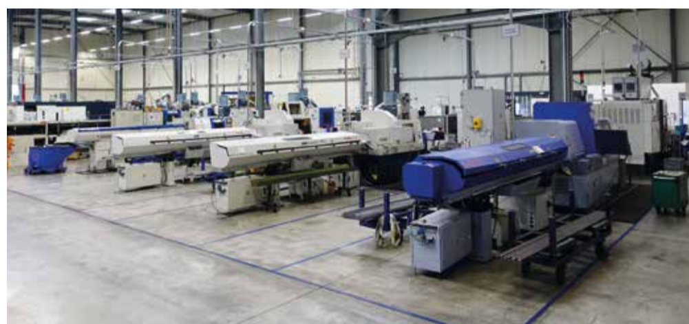
Park maszynowy WIGGENTech obejmuje około 20 wielowrzecionowych i jednowrzecionowych tokarek
