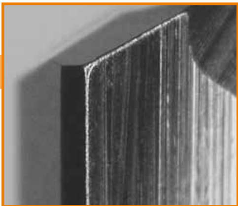
Radio del filo de corte R= 0.02mm
