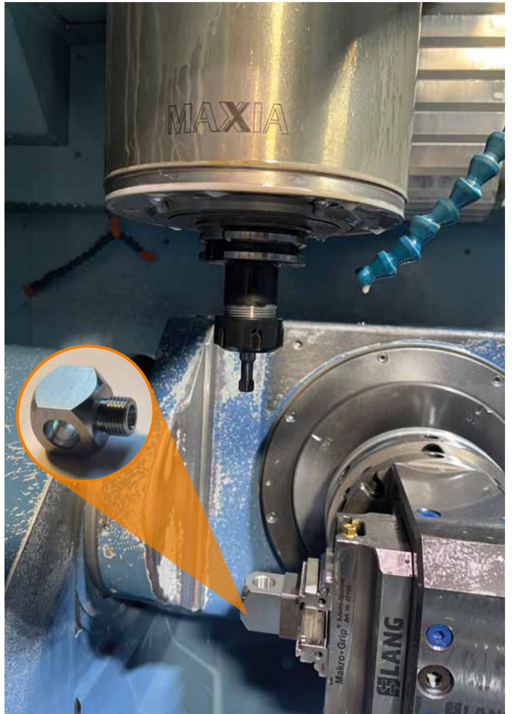
Hydrokomp-Anwendung mit Schwanog Formfräser
