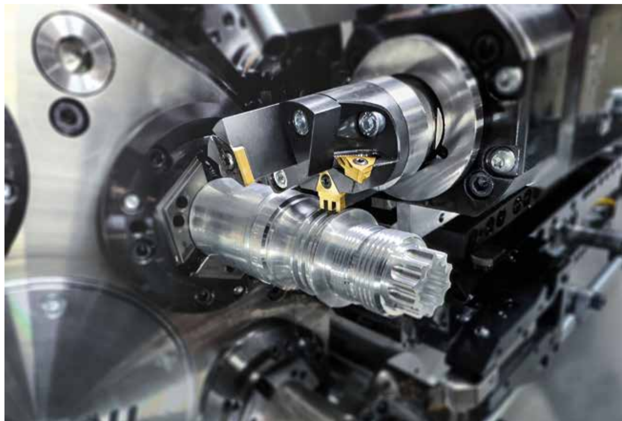
Utensile combinato HDT-2.0, placchetta per scanalatura in posizione di lavorazione
