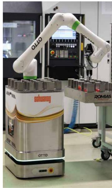
Unser neues FTS, welches seit Juni im Einsatz ist, hat seine Feuerprobe erfolgreich bestanden. Otto ist ein fahrerloses Transportsystem mit einem kollaborierenden Roboter, welches Aufträge von Fertigungsstation zu Fertigungsstation transportiert. Doch was macht Otto so neu und anders als übliche Robotic, die bei uns schon lange in abgegrenzten Bereichen im Einsatz ist?
