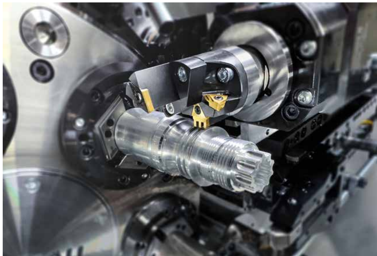
Herramienta combinada HDT-2.0, placa de perforado de forma en posición de mecanizado
